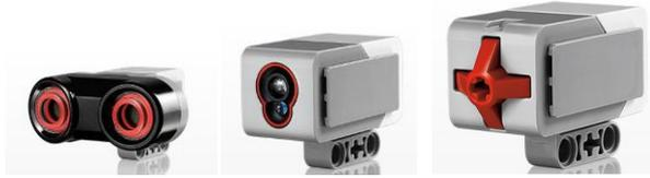
Датчик касания Ультразвуковой датчик Датчик цвета
